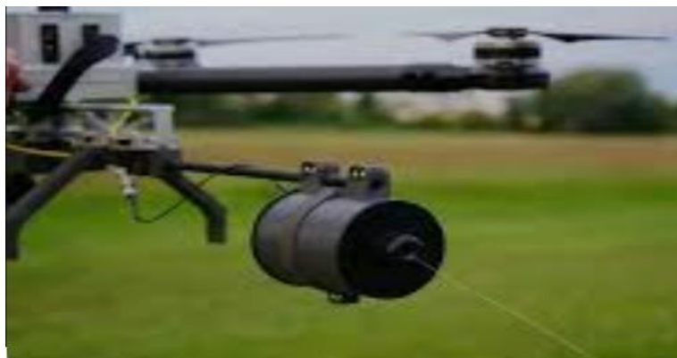
Рисунок 2. – БПЛА, управляемый с помощью оптоволоконного кабеля
