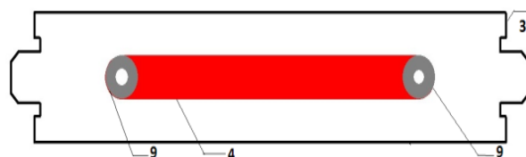
Рисунок 4 б. – Вид внутренней стороны одного из отрезков двустороннего ламината с микрополосковым отрезком, выполняющим роль ответвителя
